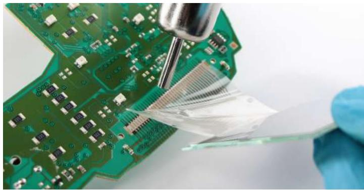
Staccare il flat del display originale dalla scheda madre, aiutandosi con un dissaldatore ad aria calda ad una temperatura non superiore a 180°C.
