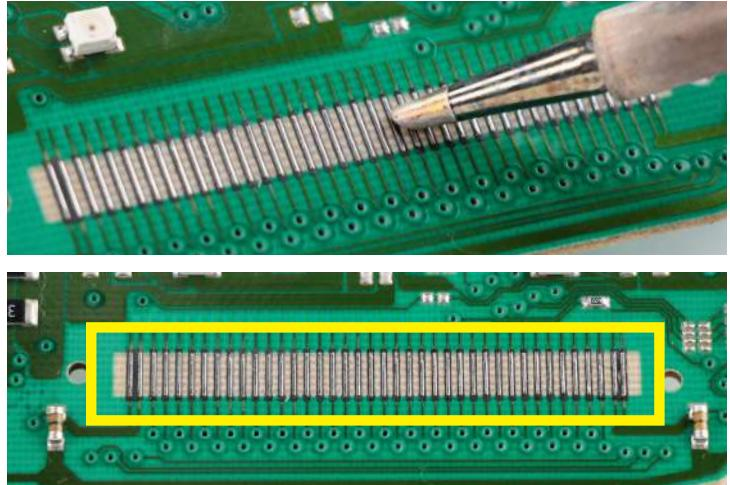
Pulire nuovamente i contatti dai residui di grafite. Per favorire la saldatura si consiglia di passare sui pin prima il flussante, poi un filo di stagno e, infine, pulire i contatti con un apposito prodotto (es. solvente).
