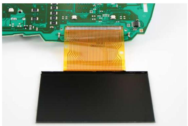
Saldare l'FPC del nuovo display sulla scheda del contachilometri utilizzando lo stagno e un saldatore ad una temperatura di 350°C.
